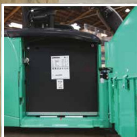
Cambio de batería lateral
